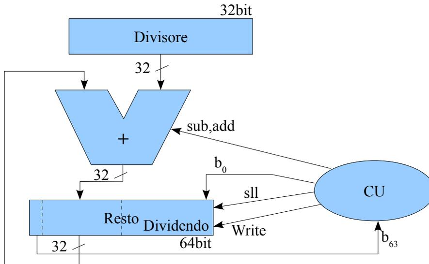
Il registro divisore (DT) viene inizializzato con il divisore e non viene shiftato durante l'esecuzione dell'algoritmo. Il registro Resto (Rem) viene inizializzato nella parte bassa con il dividendo (DD) e nella parte alta a 0. il quoziente viene via via accumulato nella parte bassa. Formalmente:
