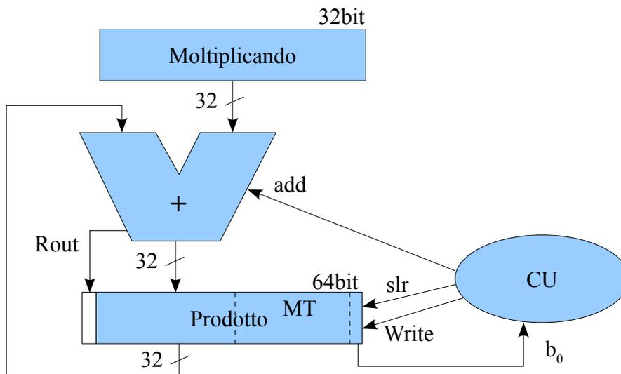
Il registro moltiplicando (MD) viene inizializzato con il moltiplicando e non viene shiftato durante l'esecuzione dell'algoritmo. Il registro prodotto (P) viene inizializzato nella parte alta a 0 mentre la parte bassa viene inizializzata con il moltiplicatore (MT). Ad ogni iterazione viene shiftato a destra di una posizione. Formalmente:
