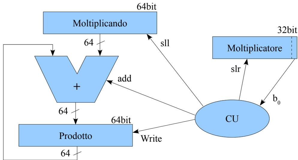
Il registro moltiplicando (MD) viene inizializzato ponendo il moltiplicando nella parte bassa e ponendo la parte alta, i bit da 32 a 63, a **0**. Il registro moltiplicatore (MT) viene inizializzato con moltiplicatore. Il registro prodotto (P) viene inizializzato interamente a **0**. Formalmente:
