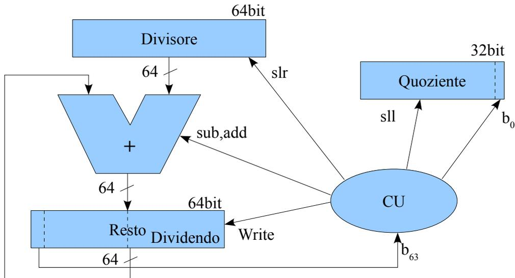
Il registro divisore (DT) viene inizializzato ponendo il divisore nella parte alta e ponendo la parte bassa, i bit da 0 a 31, a **0**. Il registro Quoziente (Q) viene inizializzato a **0**. Il registro Resto (Rem) viene inizializzato nella parte bassa con il dividendo (DD) e nella parte alta a **0**. Formalmente:
