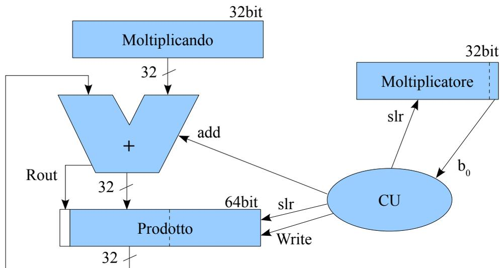
Il registro moltiplicando (MD) viene inizializzato con il moltiplicando e non viene shiftato durante l'esecuzione dell'algoritmo. Il registro moltiplicatore (MT) viene inizializzato con moltiplicatore. Il registro prodotto (P) viene inizializzato interamente a **0** e ad ogni iterazione viene shiftato a destra di una posizione. Formalmente:
